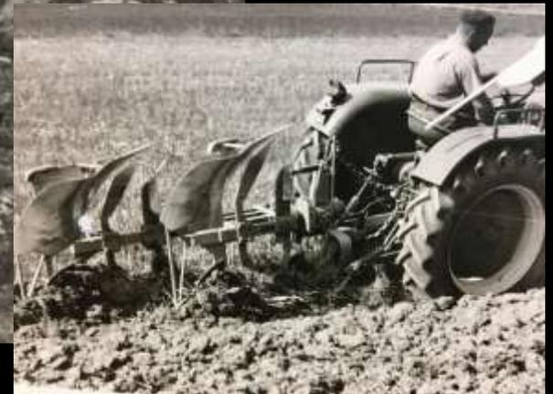
1958 Erster Zweischarpflug ohne Ausklinkung, ab 1962 dann mit Ausklinkvorrichtung
