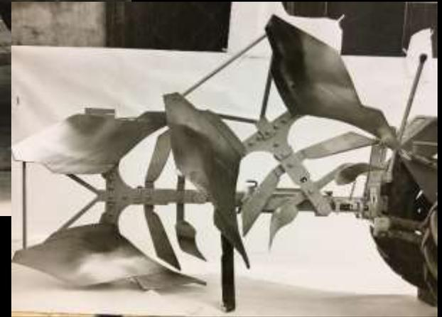
1964 Zweischarpflug HW mit der automatischen Gewichtsverlagerung (Klappe) – ein Erfolgsmodell (bis 1987)
