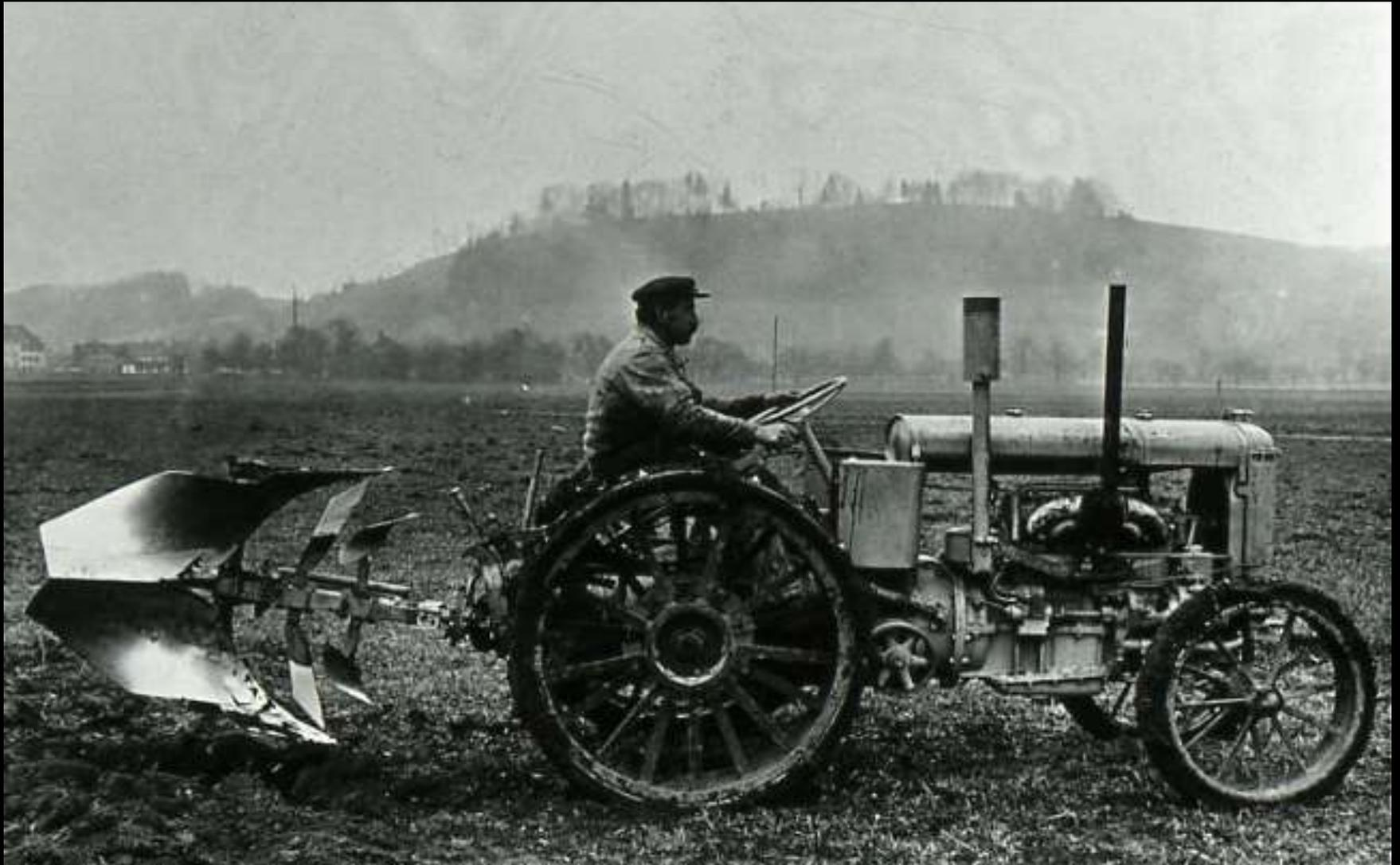
1932 Traganhänge Wendepflug (mit Ausklinkvorrichtung) für Traktoren
